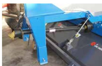
Подметально-уборочная машина присоединяется к Блоку отбора мощности (540 об/мин) трактора и в 3-х точках крепления на тракторе. Карданный вал приводит в движение щетки, расположенные внутри корпуса машины.
